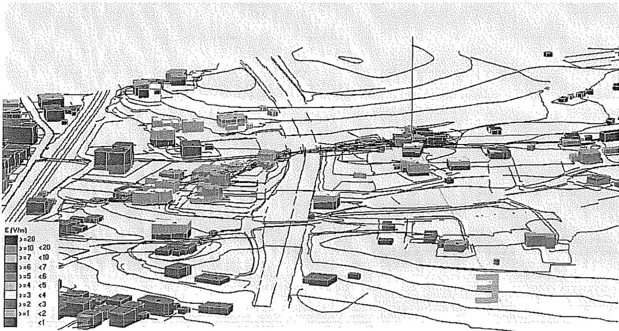
Fig. 12 Impatto Elettromagnetico – zona Via Campotondo – Vista laterale
