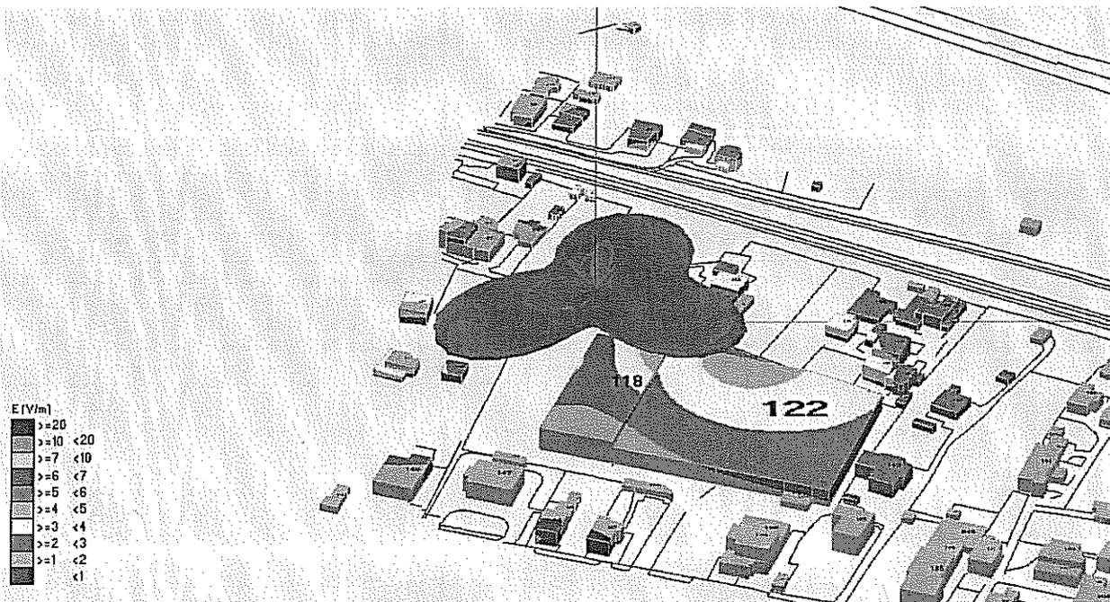
Fig. 1 Impatto Elettromagnetico – zona Scauri Ovest – 0°/Nord
