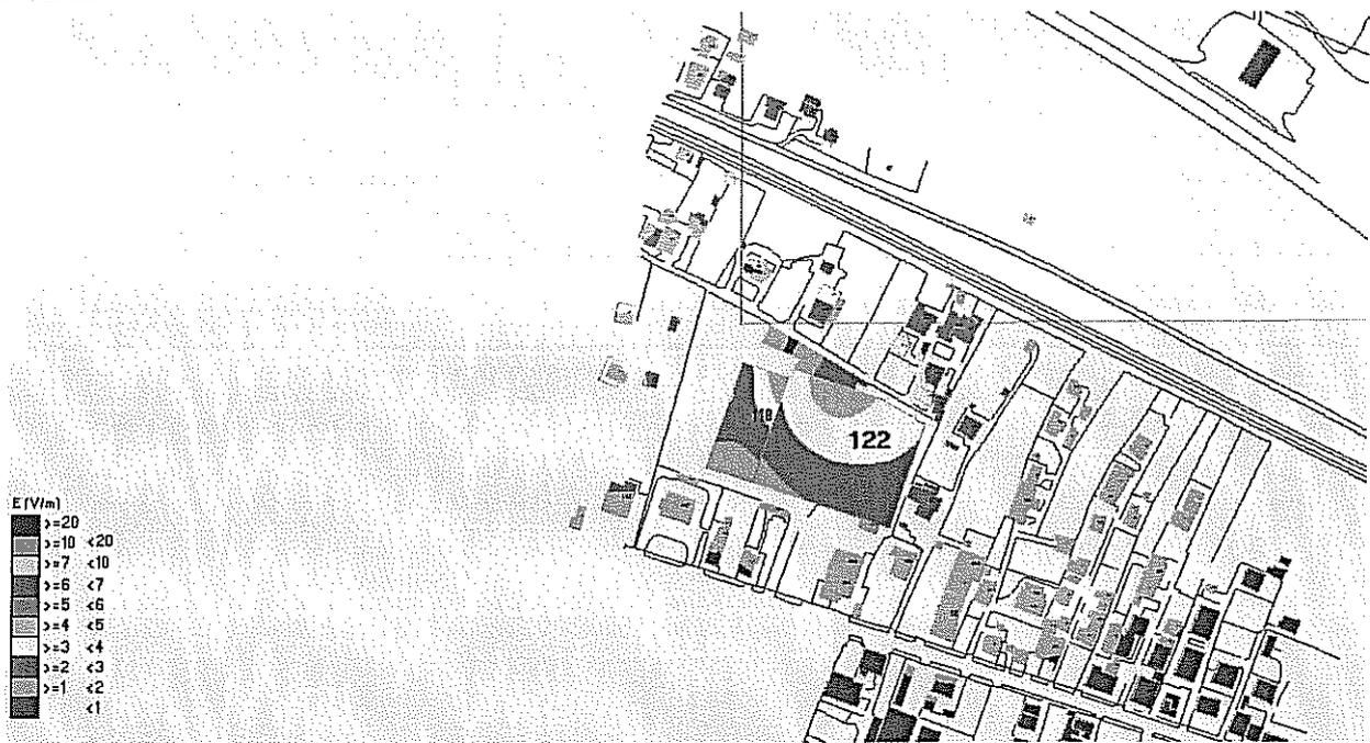
Fig. 2 Impatto Elettromagnetico – zona Scauri Ovest – Vista dall'alto
