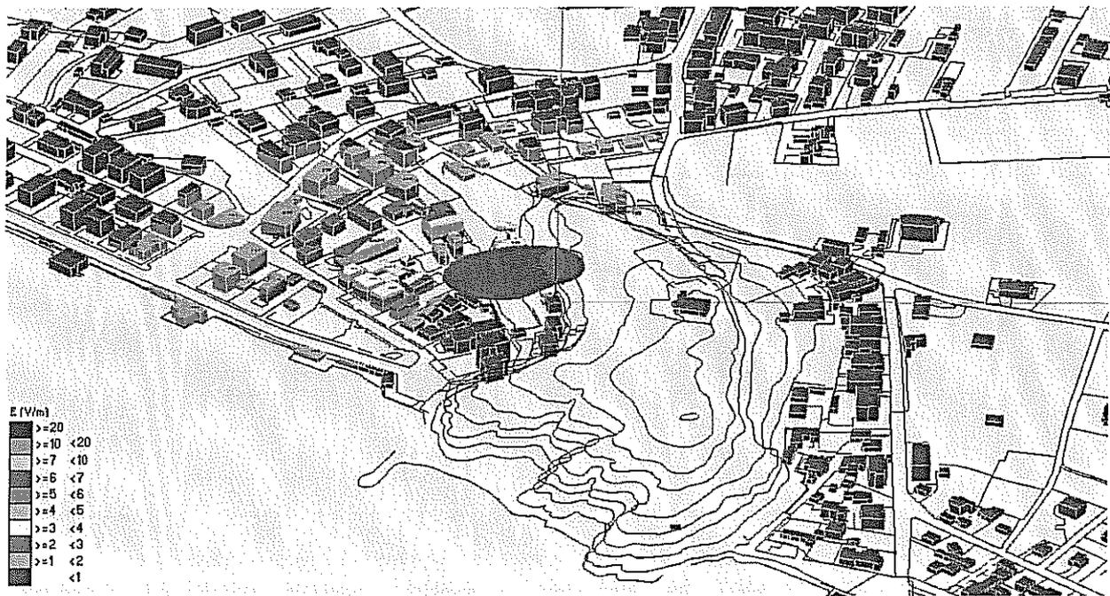
Fig. 42 Impatto Elettromagnetico – zona Monte Argento – 0°/Nord
