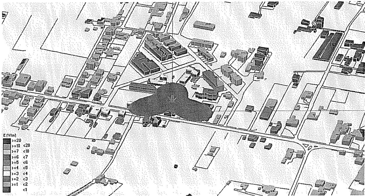
Fig. 36 Impatto Elettromagnetico – zona Via Appia – 0°/Nord
