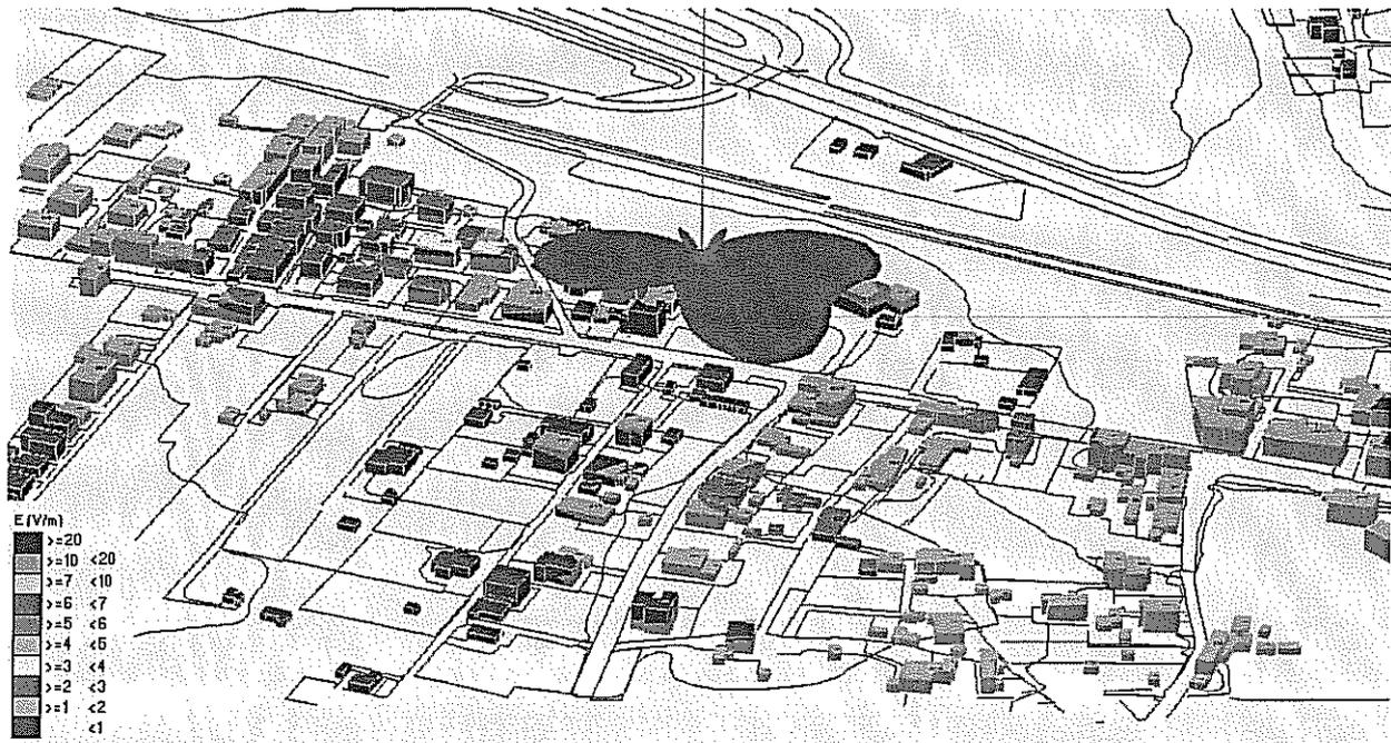
Fig. 4 Impatto Elettromagnetico – zona Torre Acquedotto SS7 – 0°/Nord
