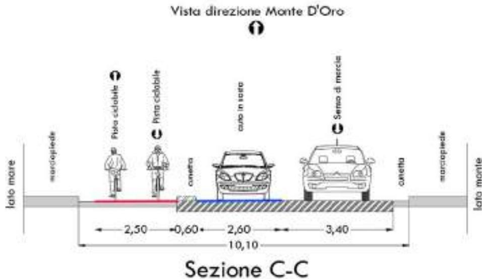
Figura 29 – Sezione tipo sede stradale e pista ciclabile
